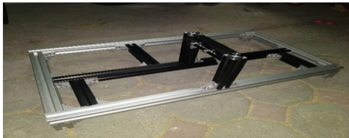
ภาพ 3.22 การประกอบโครงเครื่องจักร
