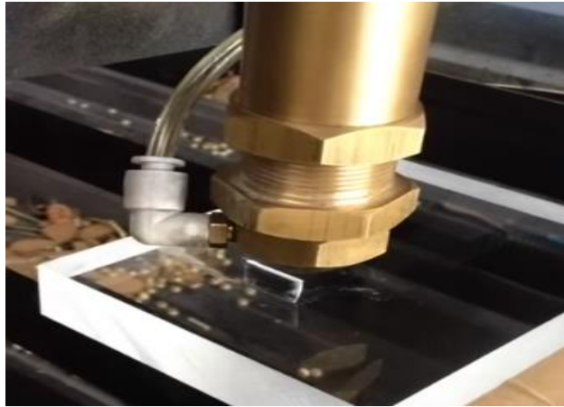
ภาพ 3.23 การขึ้นรูปชิ้นงานโดยเครื่องตัดเลเซอร์
